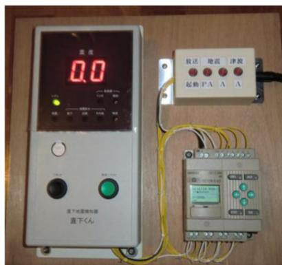
海底で大地震が発生すると津波が発生します。震源が陸に近いと津波は数分で押し寄せます。「津波から命を守る」には、素早く高台に避難する以外に方法はありません。「直下ドラゴン」の津波アラームは震度4以上の地震が連続で1分以上継続した時、自律的に津波の危険性を判定し、津波アラームを出力します。
